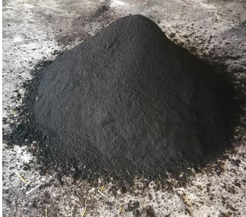
Idrochar (HC) ottenuto mediante prove effettuate con reattore C700 di Carborem
