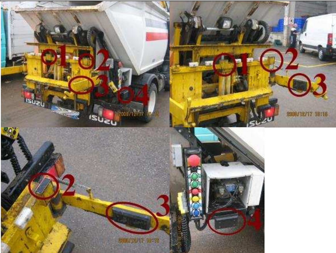
Figura 1 – Posizionamento antenne di lettura transponders LF
