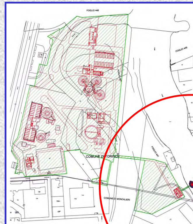
Comune di Torino – Area di salvaguardia della captazione di acqua superficiale ubicata in sponda sinistra del F. Po, con annesso impianto di potabilizzazione
